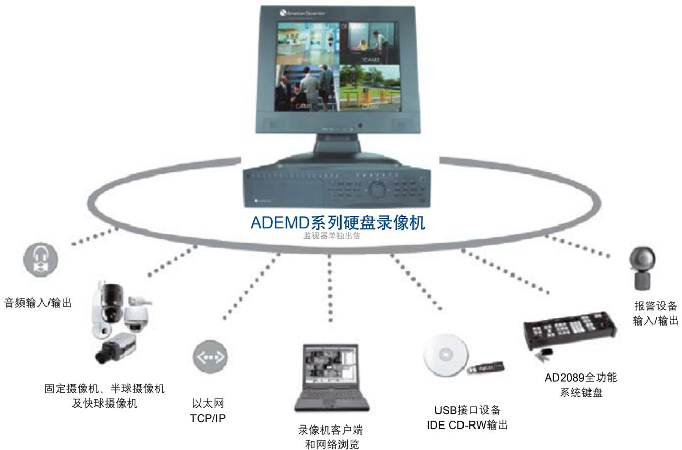
从功效强大的带有电子影像稳定技术的Ultra 8可编程快球摄影机到坚固的Discover半球摄像机, American Dynamics EDVR能记录来自任何摄影机的影像。为了更加方便, 客户可通过DVR前面板、AD2089-1键盘控制器或客户端软件控制球型摄像机。有着充足的遥摄能力或变焦能力, 因此客户可获得最佳的视图和更高的安全性能。
