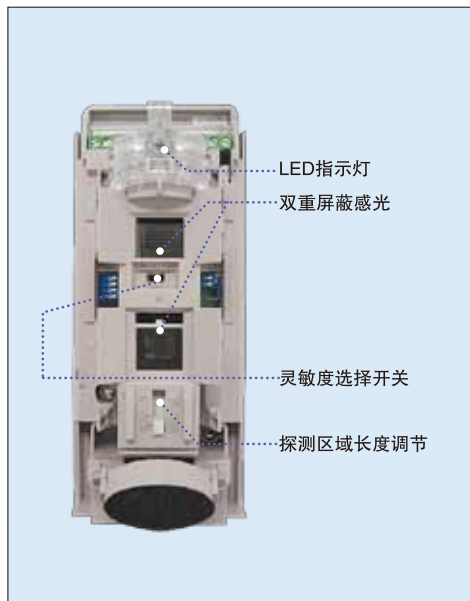
当只有下层区域探测到移动物体时，探测器不被触发
